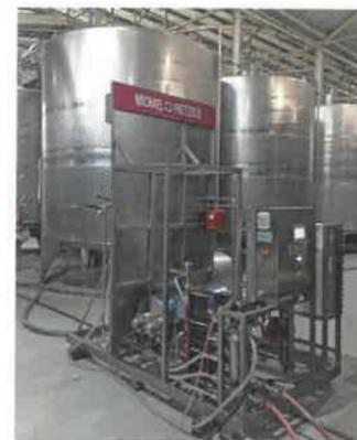
**LORSQUE L'ON DÉSALCOOLISE PARTIELLEMENT LES VINS**, il faut ajouter à l'osmoseur une colonne de distillation pour pouvoir séparer l'eau de l'alcool. L'eau est réinjectée dans le concentrat, ce qui minimise les pertes de volumes.
